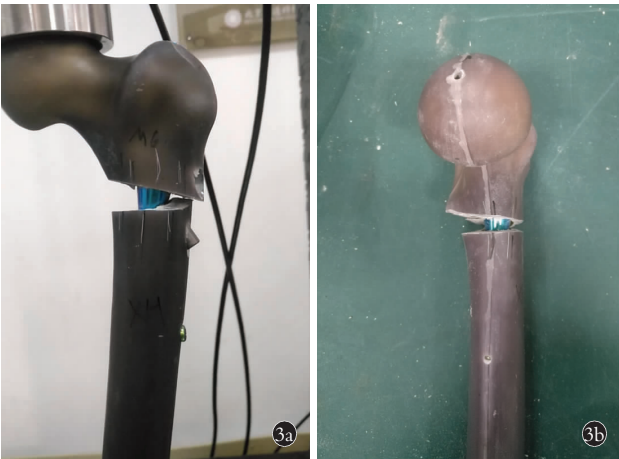
图 3 生物力学试验示意图 3a. 测试标本在生物力学测试机上进行轴向加载和轴向破坏测试 3b. 在测试标本内侧标记,测试完成后通过标记线的位移测算断端扭转角度
